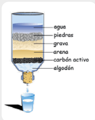
Figura 9. Ejemplos de a) Sedimentación y b) Filtración. Fuente: Serrano, 2021.
